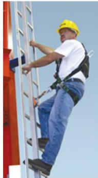
Figura 48 - Escada Tipo Marinheiro sem Gaiola
