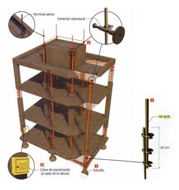
A natureza e a resistividade do solo têm que ser consideradas no estágio inicial do projeto. Este parâmetro pode ser útil para dimensionar o subsistema de aterramento, que pode influenciar certos detalhes do projeto civil das fundações.
